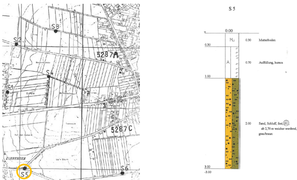
Abb. 21: 6 Rammkernsondierungen (1997) / Bohrprofil S 5
